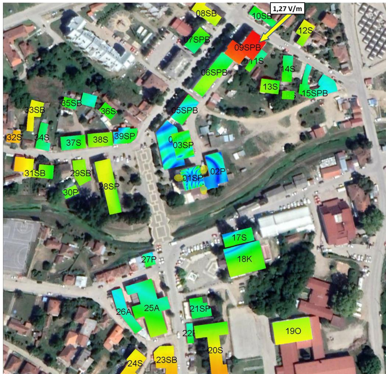
Слика 4.12. Јачина електричног поља унутар објекта када радио-систем LTE1800 оператора Telekom Srbija ради максималним капацитетом
