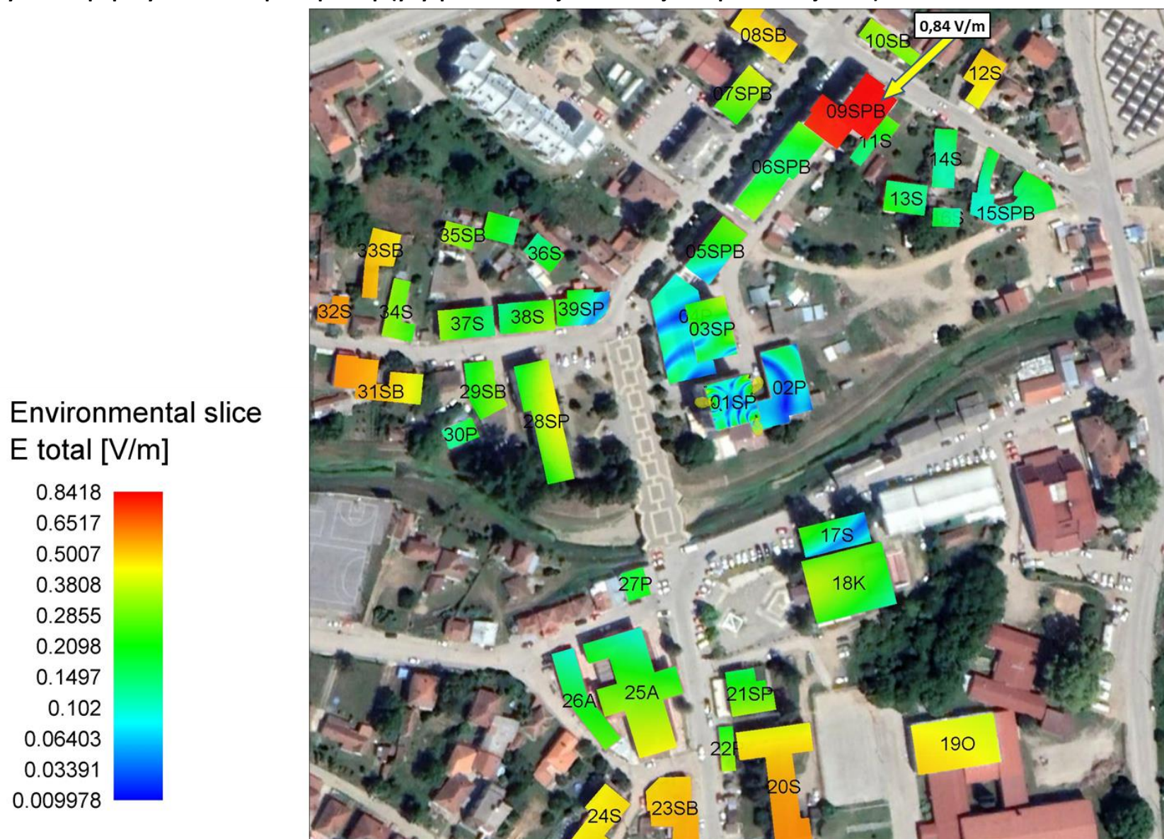
Слика 4.9. Јачина електричног поља унутар објеката када радио-систем GSM900 оператора Telekom Србија ради максималним капацитетом
