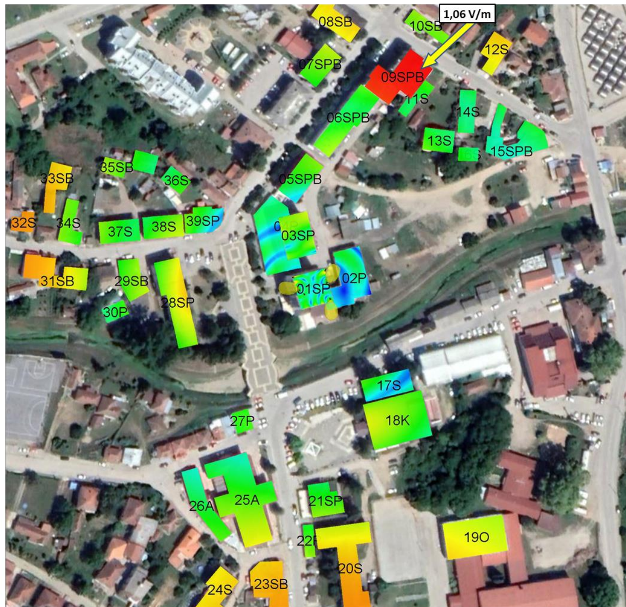
Слика 4.11. Јачина електричног поља унутар објеката када радио-систем LTE800 оператора Telekom Srbija ради максималним капацитетом
