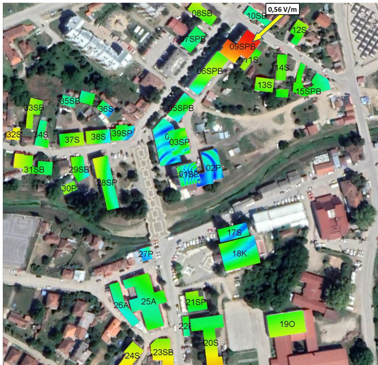
Слика 4.13. Јачина електричног поља унутар објеката када радио-систем LTE2100 оператора Telekom Srbija ради максималним капацитетом
