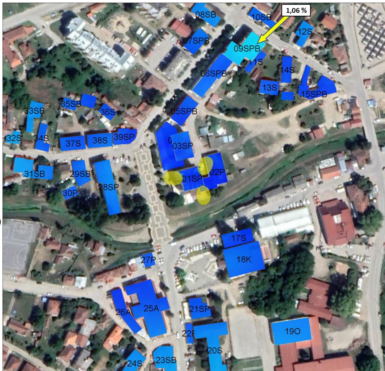
Слика 4.14. Фактор изложености унутар објеката када сви радио-системи оператора Telekom Srbija раде максималним капацитетом
